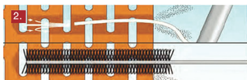
2. Очистка отверстия от пыли
