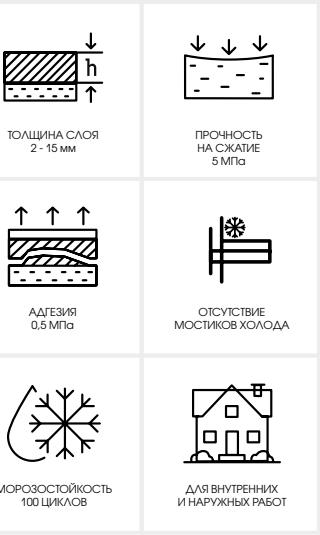
\* Зимняя серия. Благодаря специальной рецептуре, применение данного продукта позволяет осуществлять строительные и отделочные работы при отрицательных температурах до -10°C.
