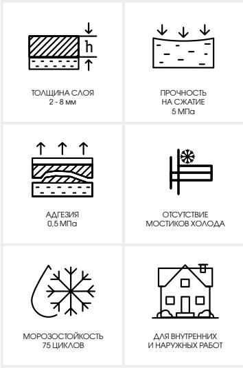
Предназначен для кладки стен и перегородок из блоков и плит ячеистого бетона (пенобетон, газобетон и газосиликат), керамзитобетона и пенополистиролбетона. Используется для тонкослойной кладки пазовых и беспазовых блоков.
