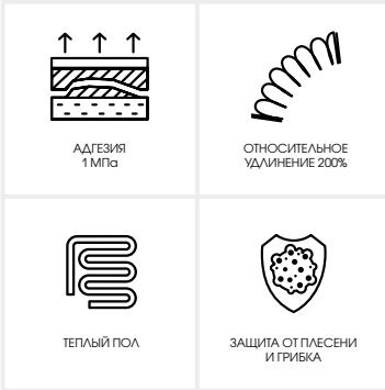
Эластичная однокомпонентная гидроизоляция, готовая к применению, на основе акриловых смол в водной дисперсии. Предназначена для создания эластичного гидроизоляционного слоя перед укладкой керамической плитки, натурального камня и мозаики во влажных и сырых помещениях, например, ванных, душевых, и других помещениях, в том числе и при устройстве «тёплых» полов.
