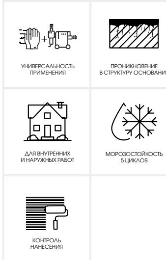
Повышает несущую способность оснований, одновременно стабилизируя и выравнивая их водопоглощение. Значительно увеличивает прочность сцепления последующих покрытий, штукатурки, шпаклевки, клеи. Особенно рекомендуется применение перед нанесением стяжек и наливных полов: а также в системах полов с подогревом. Применяется для внутренних и наружных работ. Наносится ручным или машинным способом.
